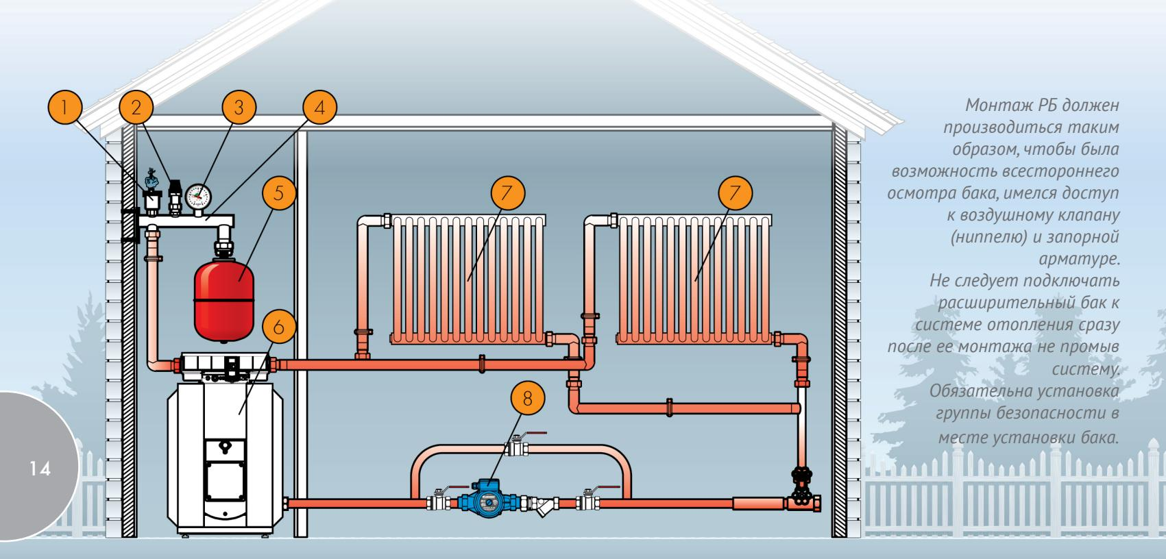
1. Воздушный клапан поплавковый, группы безопасности;
