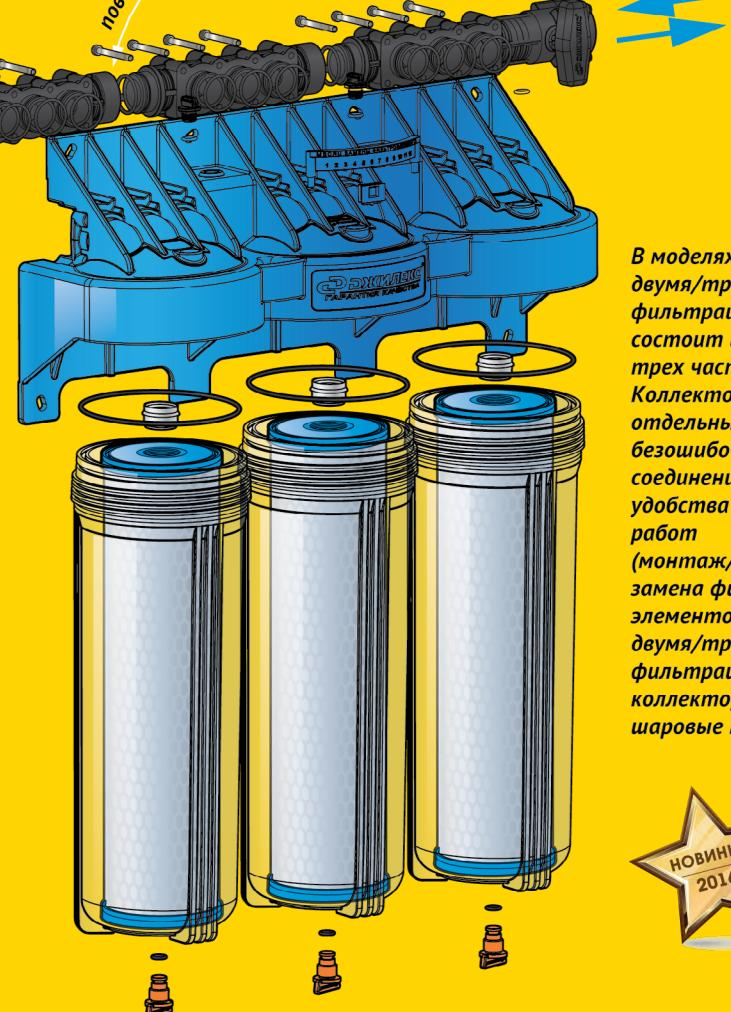
В моделях с двумя/тремя ступенями фильтрации, коллектор состоит из двух или трех частей. Коллекторы имеют отдельные пазы для безошибочного соединения. Для удобства проводимых работ (монтаж/демонтаж, замена фильтрующих элементов) в моделях с двумя/тремя ступенями фильтрации на концах коллектора встроены шаровые краны.
