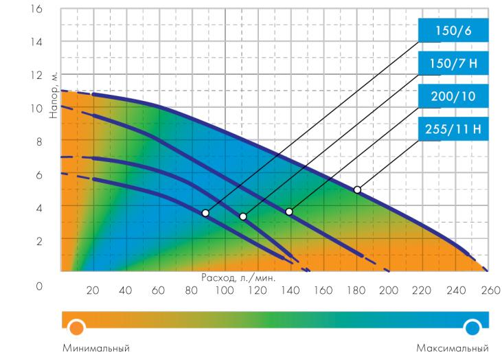
Данные характеристики были получены экспериментальным путем, в испытательной лаборатории завода «ДЖИЛЕКС», при перекачивании чистой воды, без примесей и газов, с использованием стабилизатора напряжения, и магистральной трубы максимального диаметра.
