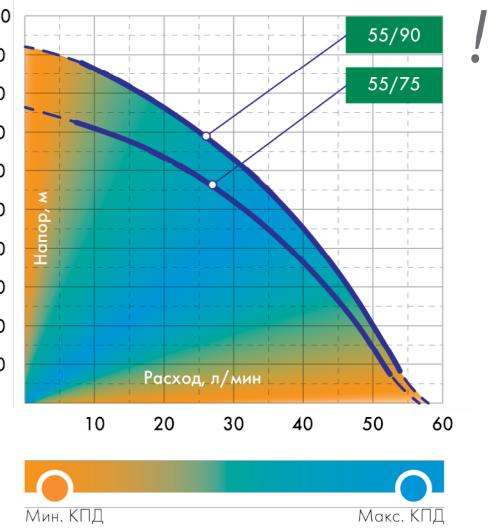
! Данные характеристики были получены экспериментальным путем, при перекачивании чистой воды, без примесей и газов, с использованием стабилизатора напряжения, и магистральной трубы соответствующего диаметра.
