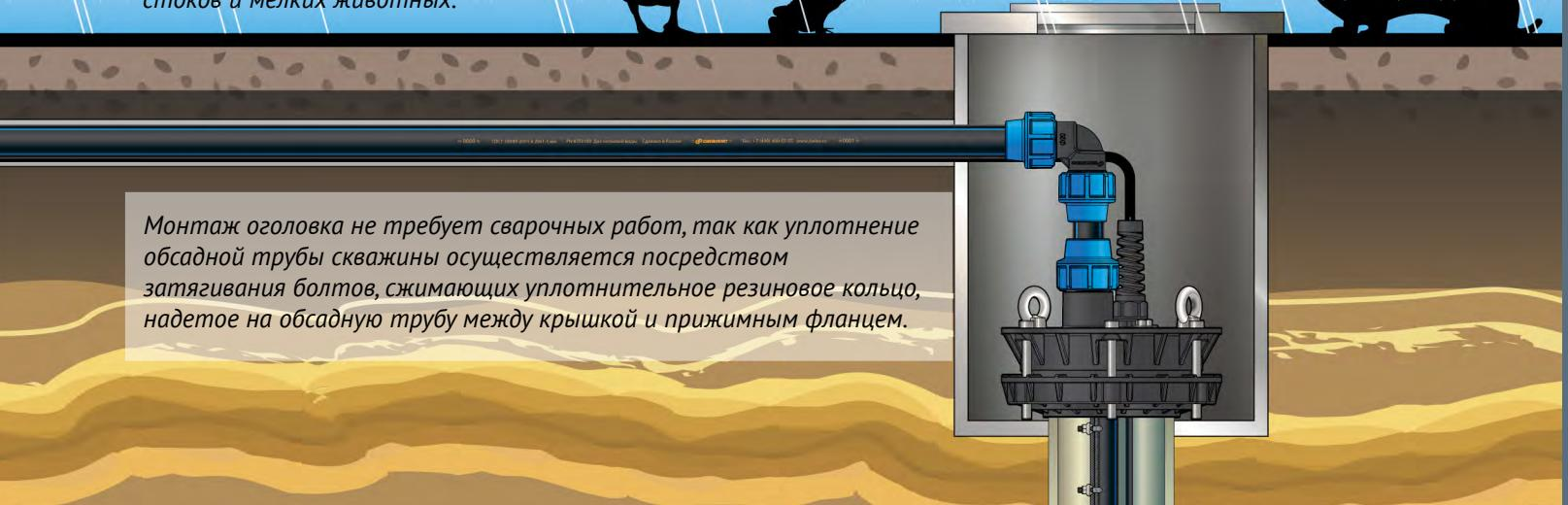
Монтаж оголовка не требует сварочных работ, так как уплотнение обсадной трубы скважины осуществляется посредством затягивания болтов, сжимающих уплотнительное резиновое кольцо, надетое на обсадную трубу между крышкой и прижимным фланцем.
