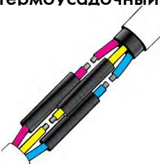
Предназначен для герметичного соединения электрического кабеля при наращивании.
