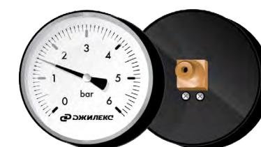
Манометр MDA 50/6 (аксиальный) предназначен для измерения давления в системах водоснабжения. Измеряет избыточное давление — положительную разность между абсолютным и барометрическим давлением.
