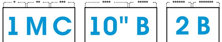
\* Обозначение диаметра трубной цилиндрической резьбы входного/выходного отверстий ( $\frac{1}{2}$ ",  $\frac{3}{4}$ ", 1");
