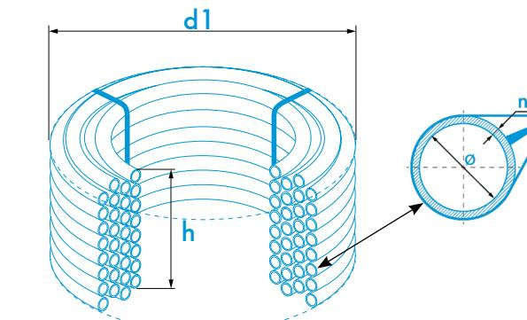
Трубы ПНД сматываются в удобные для транспортировки и хранения бухты, которые помещаются в дверных проёмах в месте предполагаемой установки и продажи.
