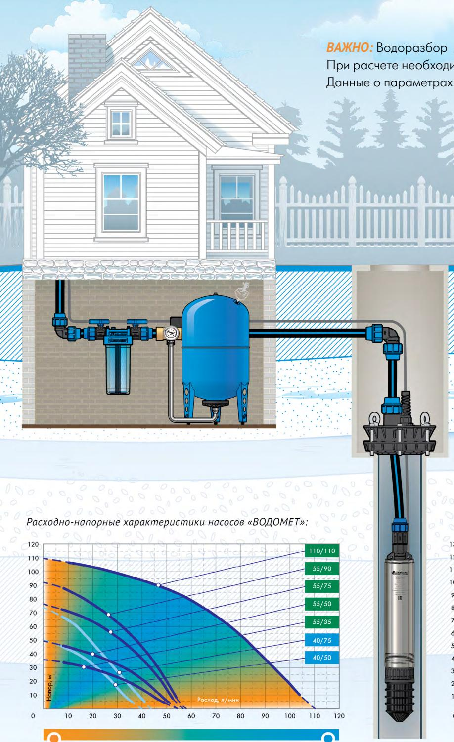
**ВАЖНО:** Водоразбор должен быть меньше дебита скважины на 10-15%. При расчете необходимо уточнить наличие фильтрующих элементов. Данные о параметрах скважины находятся в её паспорте.
