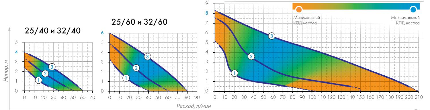
! Данные характеристики были получены экспериментальным путем, при перекачивании чистой воды, без примесей и газов, с использованием стабилизатора напряжения, и магистральной трубы соответствующего диаметра.
