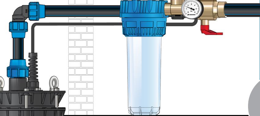
В корпус фильтра, входящий в комплект, необходимо установить фильтрующий элемент с пропускной способностью 50-100 мкм (фильтр грубой очистки), при условии его своевременной замены. Более тонкую очистку необходимо устанавливать, только после преобразователя давления (датчика давления).
