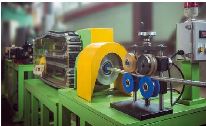
Процесс гофрирования трубы
